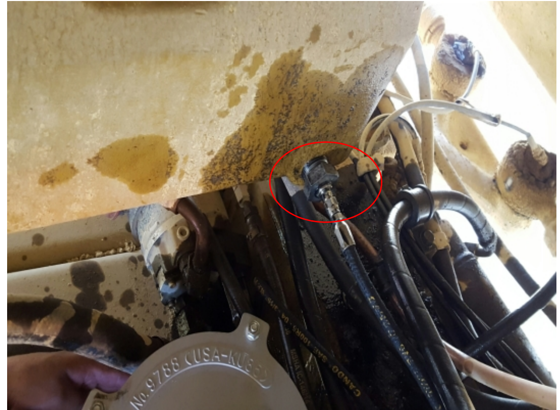
Retorno del Aceite Filtrado hacia el Motor. CONEXIÓN AL CARTER DEL MOTOR
