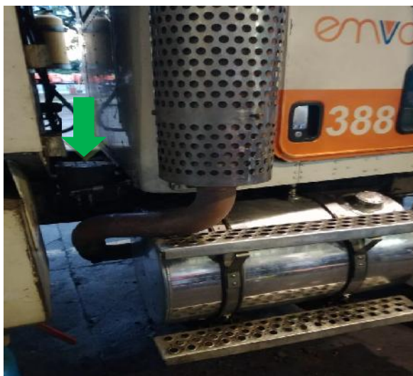
Instalación Kleenfuel en el tanque de combustible
