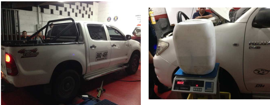
Figura 1. Montaje del vehículo en el dinamómetro y recipiente auxiliar para medida de consumo de combustible.
